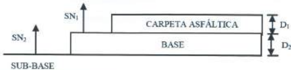
FIGURA 20: REPRESENTACIÓN ESQUEMÁTICA PARA CALCULAR EL ESPESOR DE LA CAPA BASE
