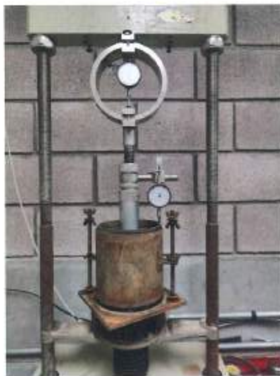
IMAGEN 9: PROCESO DE SATURACIÓN Y ENSAYO CBR
