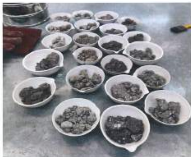
IMAGEN 4: ENSAYO DE CONTENIDO NATURAL DE AGUA
