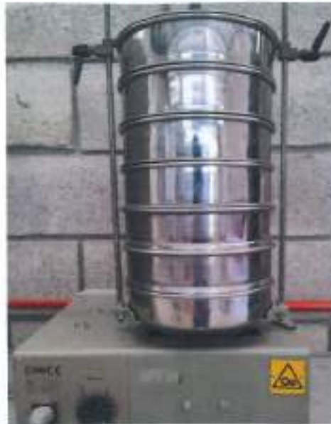
IMAGEN 5: ENSAYO DE GRANULOMETRÍA
