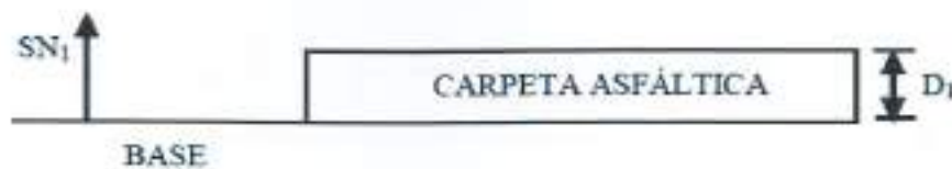
FIGURA 19: REPRESENTACIÓN ESQUEMATICA PARA CALCULAR EL ESPESOR DE LA CAPA ASFALTICA
