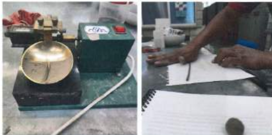
IMAGEN 7: ENSAYO DE LIMITES DE CONSISTENCIA
