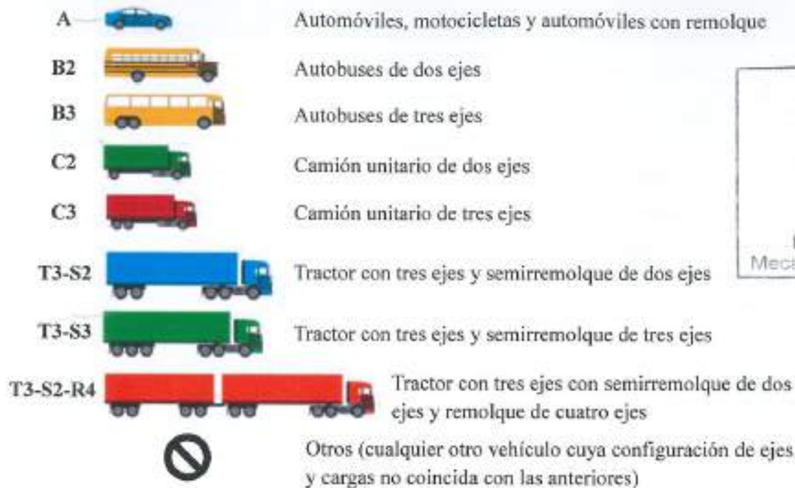
FIGURA 15: CLASIFICACIÓN VEHÍCULAR DEL INSTITUTO MEXICANO DEL TRANSPORTE (IMT), TOMADO DE IMT-PAVE 3.0
